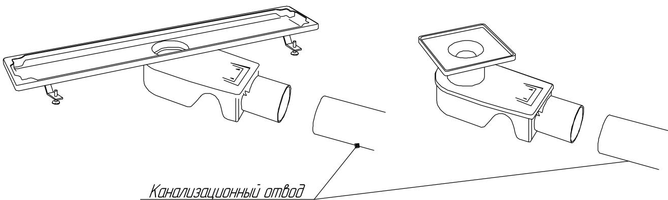
*Выход отвода трапа соедините с отводящей трубой канализации, произведите монтаж гидроизоляционного материала. Залейте место установки трапа стяжкой с уклоном не менее 2% от основного пола. Уложите керамическую плитку.*
