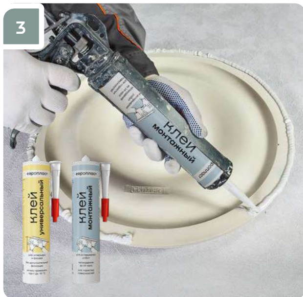
3 Равномерно нанести на монтажную поверхность клей «Европласт Монтажный» или «Европласт Универсальный» по всей окружности изделия. Толщина наносимого слоя клея должна составлять 3–5 мм.
