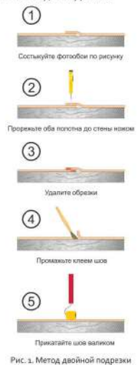
Рис. 1. Метод двойной подрезки
